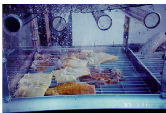
保温材による閉塞実験の様子 出典：BWR ECCS STRAINER BLOCKAGE ISSUE: SUMMARY OF RESEARCH AND RESOLUTION ACTIONS/Los Alamos National Laboratory
